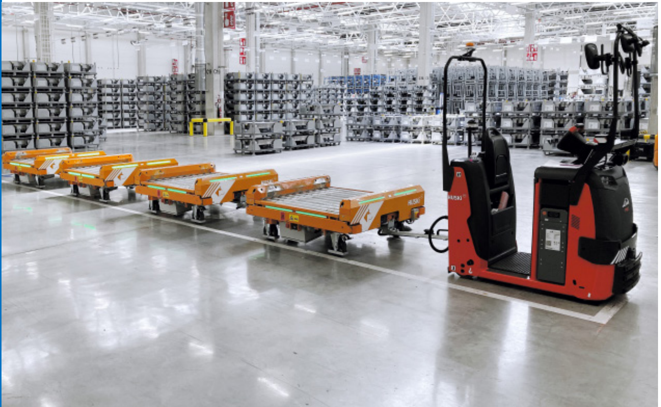
Routenzug zur Belieferung der Batteriezellmontage bei der Daimler AG
