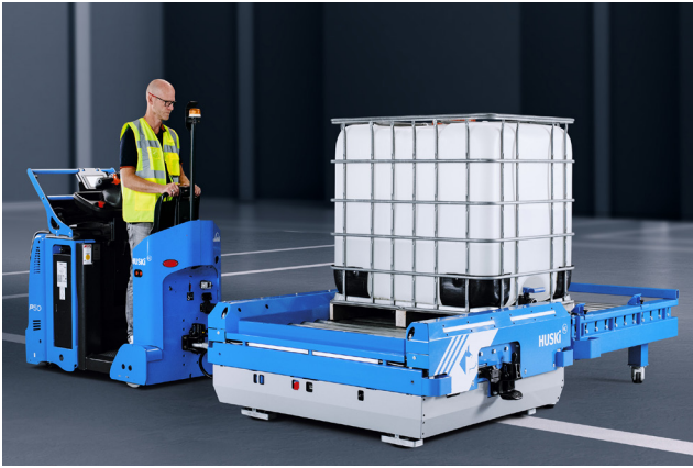
Automatischer Ladungsträgerwechsel für Gewichte bis zu 2 Tonnen
